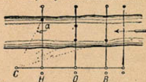
Фиг. 182. Определение места прохода поплавков при помощи угломера.
