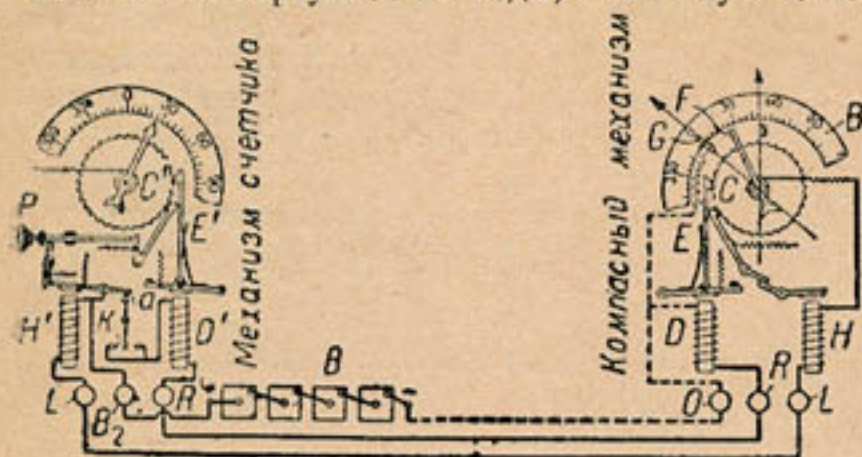
Фиг. 147. Схема работы вертушки Отта, тип VIIh.
