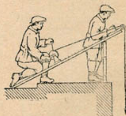
Фиг. 126. Опускание вертушки с моста.
